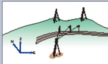
Replanteo tridimensional en coordenadas X,Y,Z o Y,X,Z.
